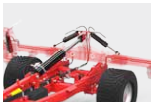
Гидравлическая регулировка работы с помощью держателя U910
