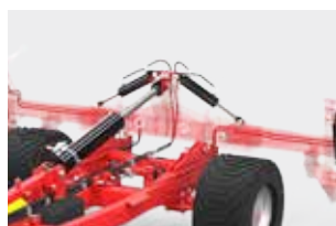
Гидравлическая регулировка работы с помощью держателя U910
