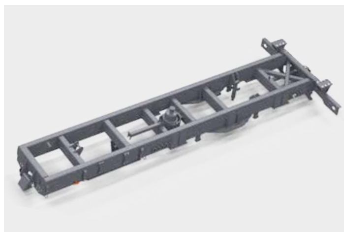
Несущий рама изготовлена из прямоугольной трубы
