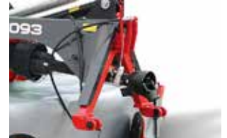
Треугольник сцепного устройства В стандартной комплектации позволяет подсоединять машину к трактору.
