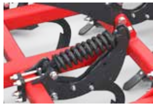
Винтовая защита - защита рабочих органов от перегрузок
