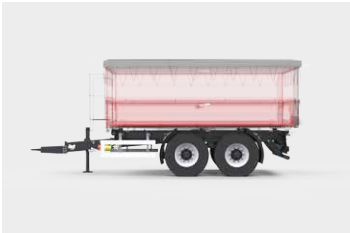
Используется шасси тандемного типа – большой комфорт и безопасность вождения
