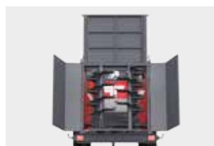
Гидравлически поднимаемая задняя стенка, уплотненная в нижней части резиновой лентой
