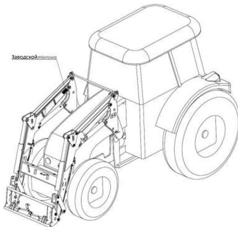
Рис.1 Расположение заводского щитка
